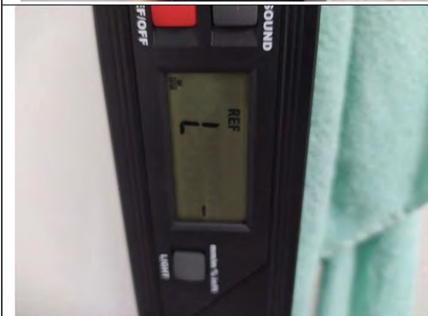
Фото №8. Измерения уровня стен в ванной комнате.
