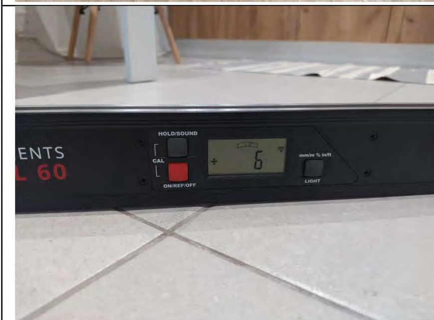
Фото №11. Измерения уровня напольного покрытия в кухне (керамическая плитка).
