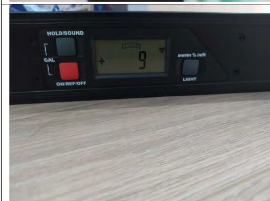
Фото №9. Измерения уровня напольного покрытия в спальне.
